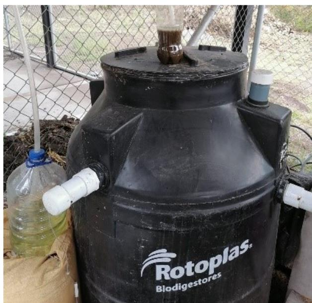
Figura 1 | Biodigestor comercial tipo batch.
